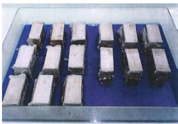
吸水試験の結果、未処理のサンプルは吸水層の厚さが0.11mmだったのに対し、OSHIROXコートを塗布したサンプルは0.01～0.04mmと大幅に表面からの吸水が抑制されていました。ウェザーメーター試験3000時間の照射は10年～15年の暴露試験に相当すると言われており、よってOSHIROXの含浸コートの耐用年数は少なくとも10年以上であると言えます。
