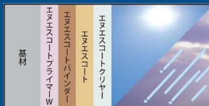
紫外線劣化に強いシロキサン結合により高耐候性を発揮します。
