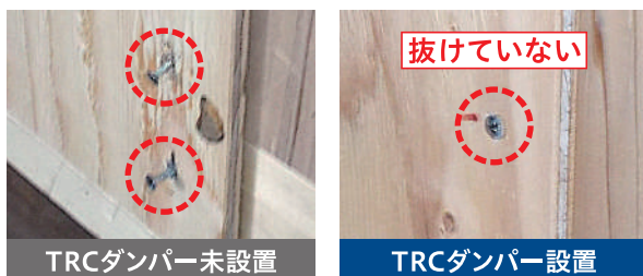
繰り返し地震3回目での釘抜けの様子
